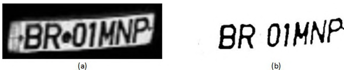
Fig. 4.7 Număr de înmatriculare segmentat; (a) Imaginea originală; (b) Rezultat final segmentare;
