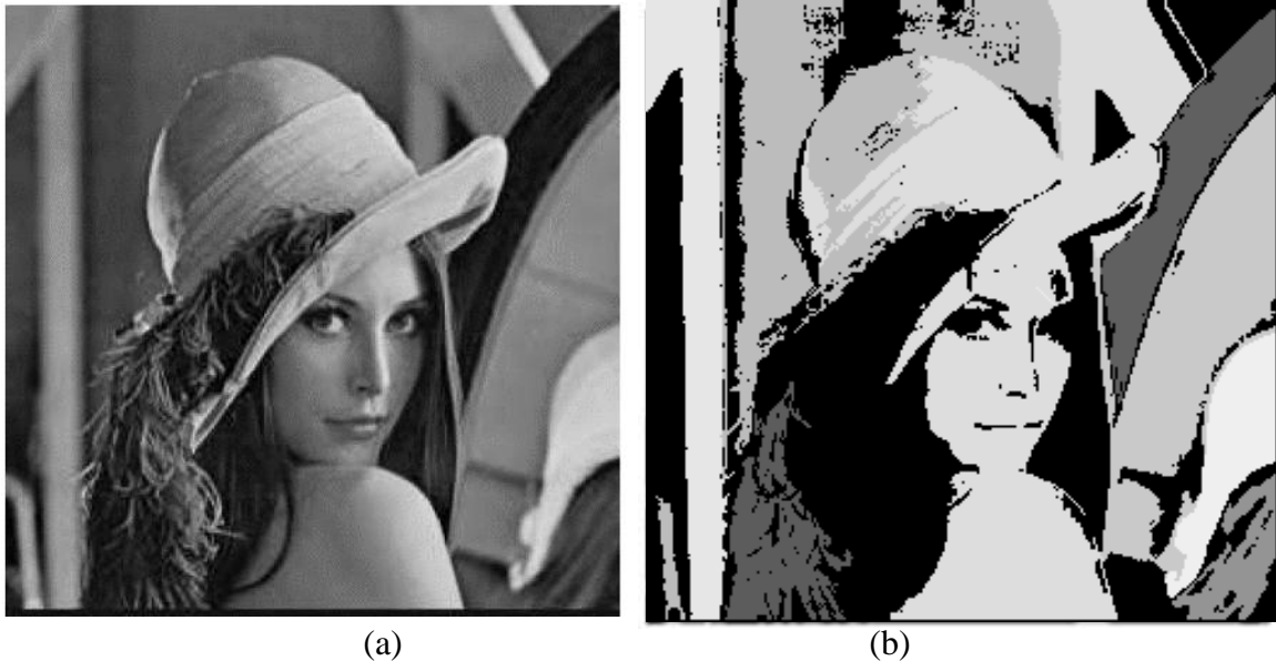
Fig. 3.5 Algoritmul SOM de segmentare aplicat pe imaginea clasică Lena (a) Imaginea originală; (b) Imaginea segmentată; (4 clase)
