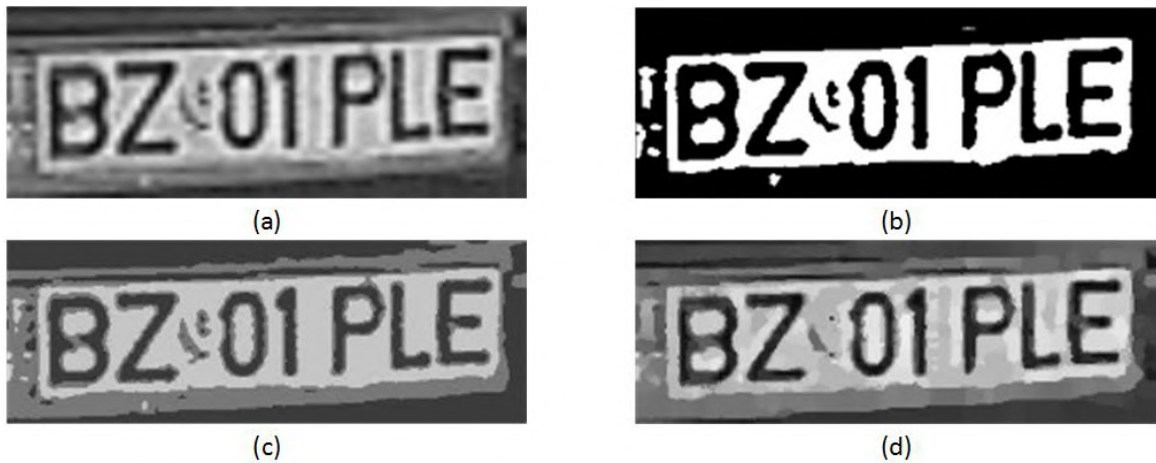
Fig. 8.3 (4.6) Număr de înmatriculare murdar pe timp de zi; (a) Imaginea originală; (b) Rezultat PCNN; (c) Rezultat SOM; (d) Rezultat Mean Shift;
