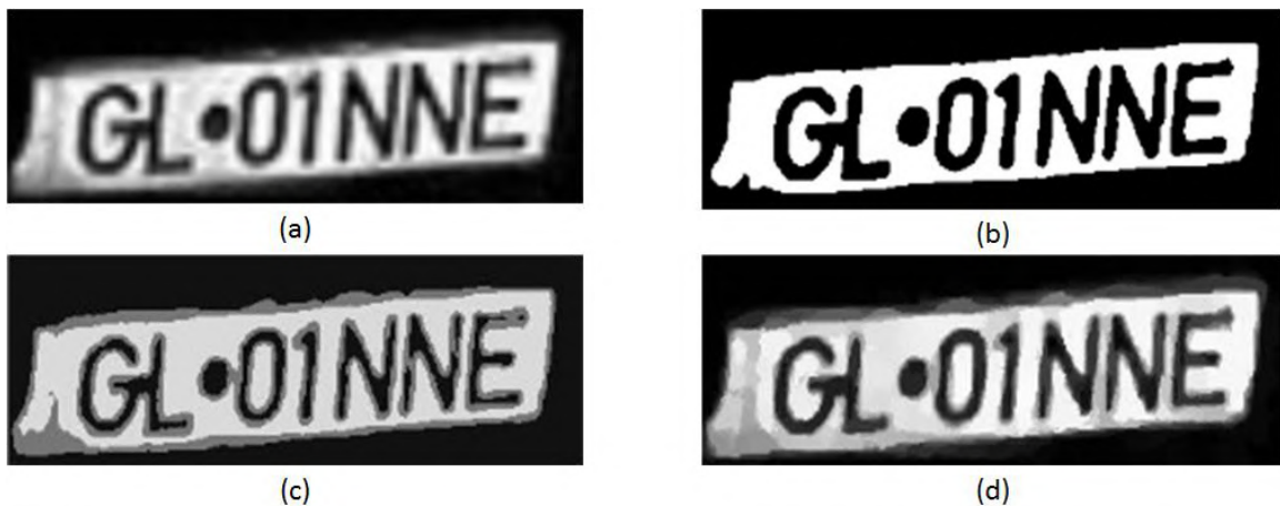
Fig. 4.5 Număr de înmatriculare curat pe timp de noapte; (a) Imaginea originală; (b) Rezultat PCNN; (c) Rezultat SOM; (d) Rezultat Mean Shift;
