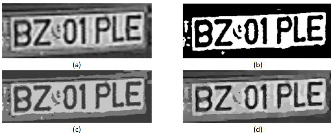
Fig. 4.6 Număr de înmatriculare murdar pe timp de zi; (a) Imaginea originală; (b) Rezultat PCNN; (c) Rezultat SOM; (d) Rezultat Mean Shift;
