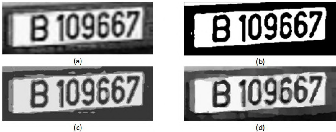
Fig. 4.4 Număr de înmatriculare curat pe timp de zi; (a) Imaginea originală; (b) Rezultat PCNN; (c) Rezultat SOM; (d) Rezultat Mean Shift;
