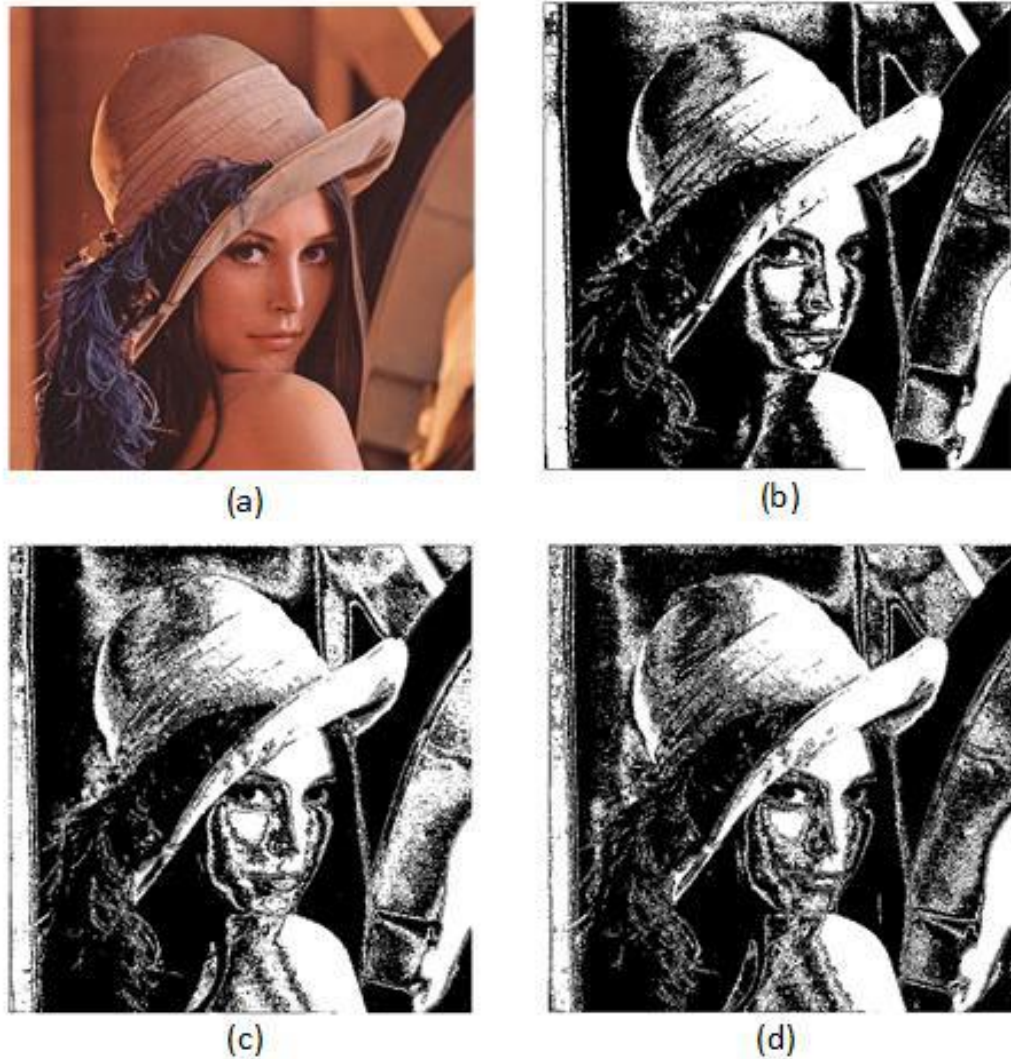
Fig. 2.6 Exemplificarea funcționării modelului PCNN. (a) Imaginea originală; (b) Ieșirea modelului PCNN - 3 iterații; (c) Ieșirea modelului PCNN - 5 iterații; (d) Ieșirea modelului PCNN - 7 iterații; (Pixelii albi reprezentand neuronii activați)
